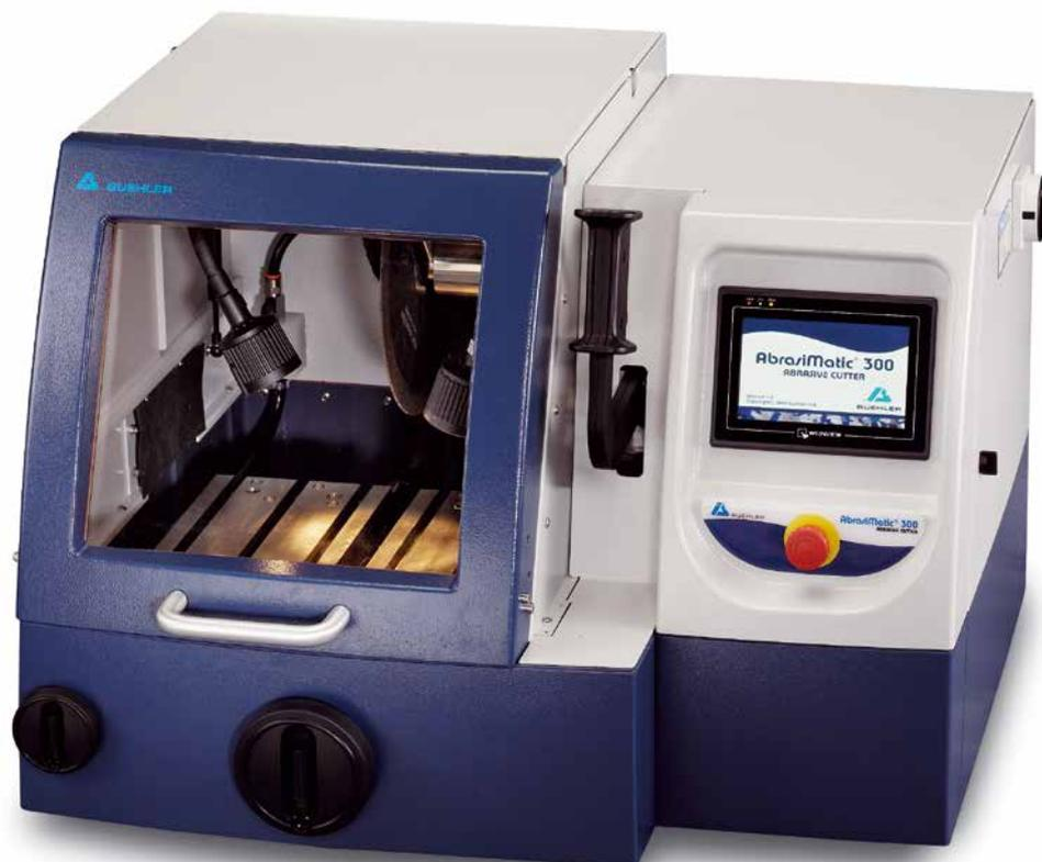
AbrasiMatic 300 est une tronçonneuse compacte de paillasse mais qui peut être installée sur son meuble (en option). Conçue avec des matériaux de qualité et des peintures de nouvelle génération, elle est idéale en contrôle production comme dans tous laboratoires R&D.
